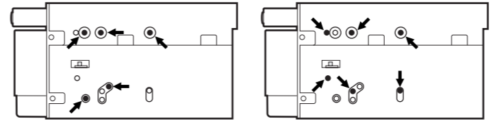
*上図の●部は、日産車に取り付ける場合に使用する穴です。 *上図の●部は、トヨタ車に取り付ける場合に使用する穴です。
