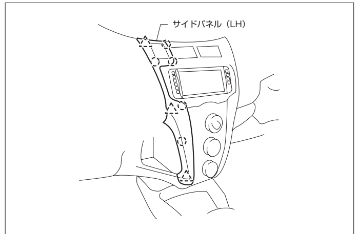
(2) サイドパネル(LH)を取外します。
