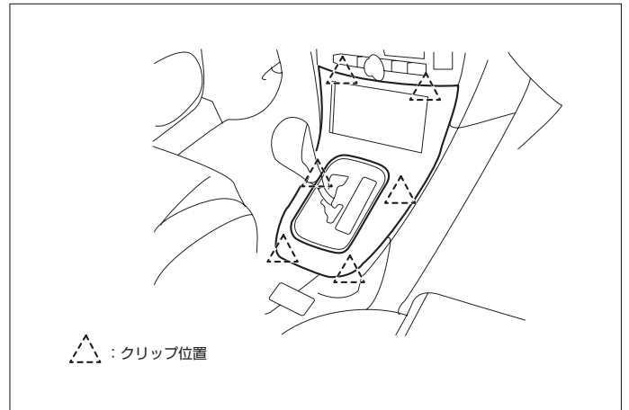
(2) シフトレバーパネルを取外します。
