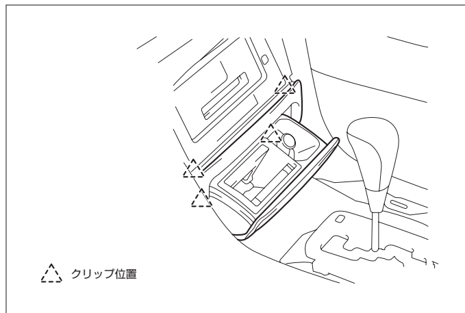
(2) フロント灰皿A'ssyを取外します。
