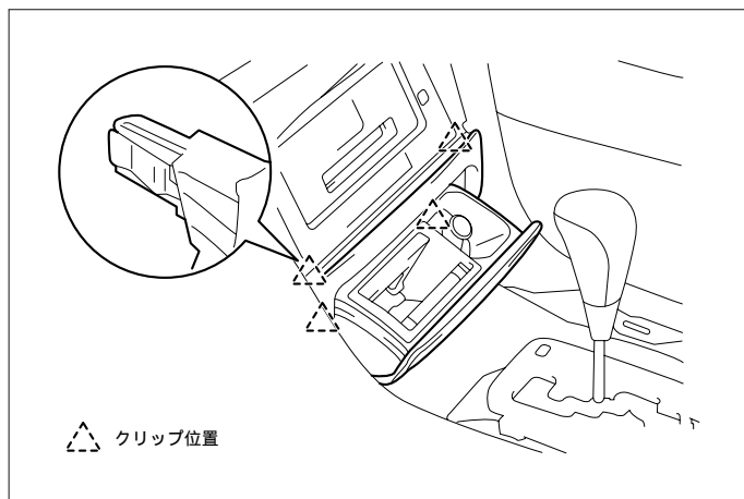
(2) フロント灰皿A ssyを取外します。
