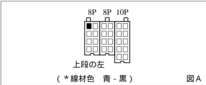
車速信号用コネクター接続位置と線材色
