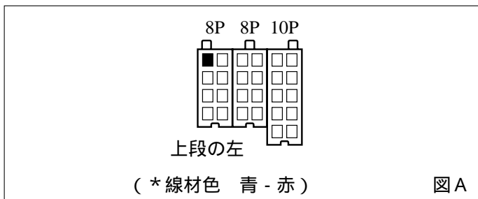
車速信号用コネクタ接続位置と線材色
