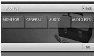
3. Tippen Sie zum Einstellen des Winkels des LCD-Bildschirms wiederholt auf die Schaltfläche **[Tilt]**. Mit jedem Tippen auf die Schaltfläche **[Tilt]** neigt sich der LCD-Bildschirm weiter nach vorne oder hinten. Der eingestellte Winkel wird gespeichert.
